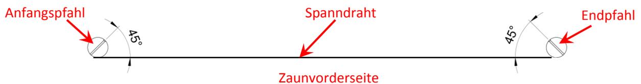
15) Spanndraht am Anfangspfahl, von der „Zaunseite“, durch die vorgebohrten Löcher einfädeln und mit einem Aufmaß von ca.  $30\text{cm}$ , einmal um den Pfahl führen.
